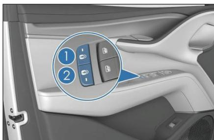
차일드락 버튼 ① 또는 버튼 ②을 누르면 탑승자는 차량 내부에서 뒷좌석의 도어를 열 수 없으며 뒷좌석 윈도우 스위치로 창문을 올리거나 내릴 수도 없습니다. 차량 뒷좌석 도어를 열려면 차일드락 기능 버튼을 다시 눌러 잠금을 해제하거나 차량 외부의 도어 핸들을 사용해야 합니다.
